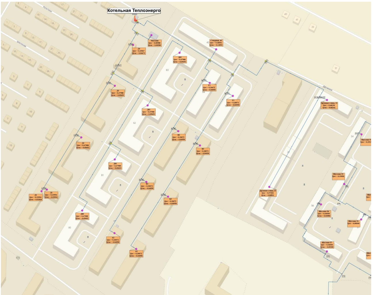
Рисунок 1.5 Схема тепловых сетей БМК ООО «ТЕПЛОЭНЕРГО»
