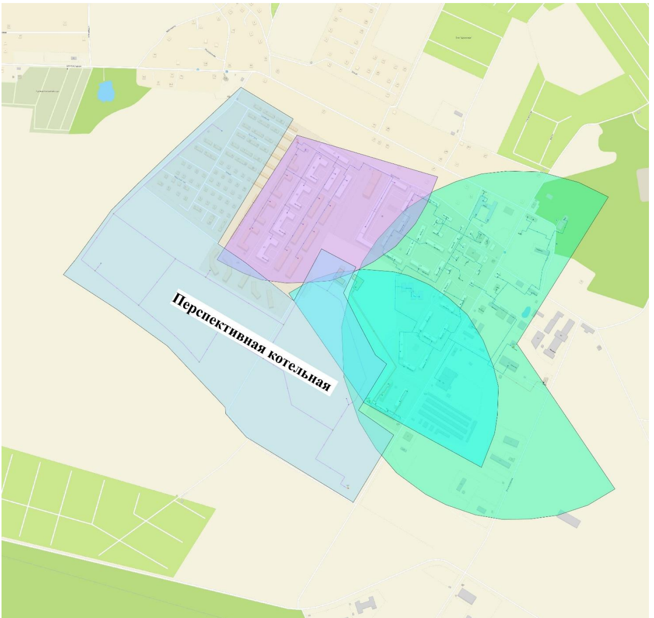
Рисунок 7.1 Радиус эффективного теплоснабжения котельных
