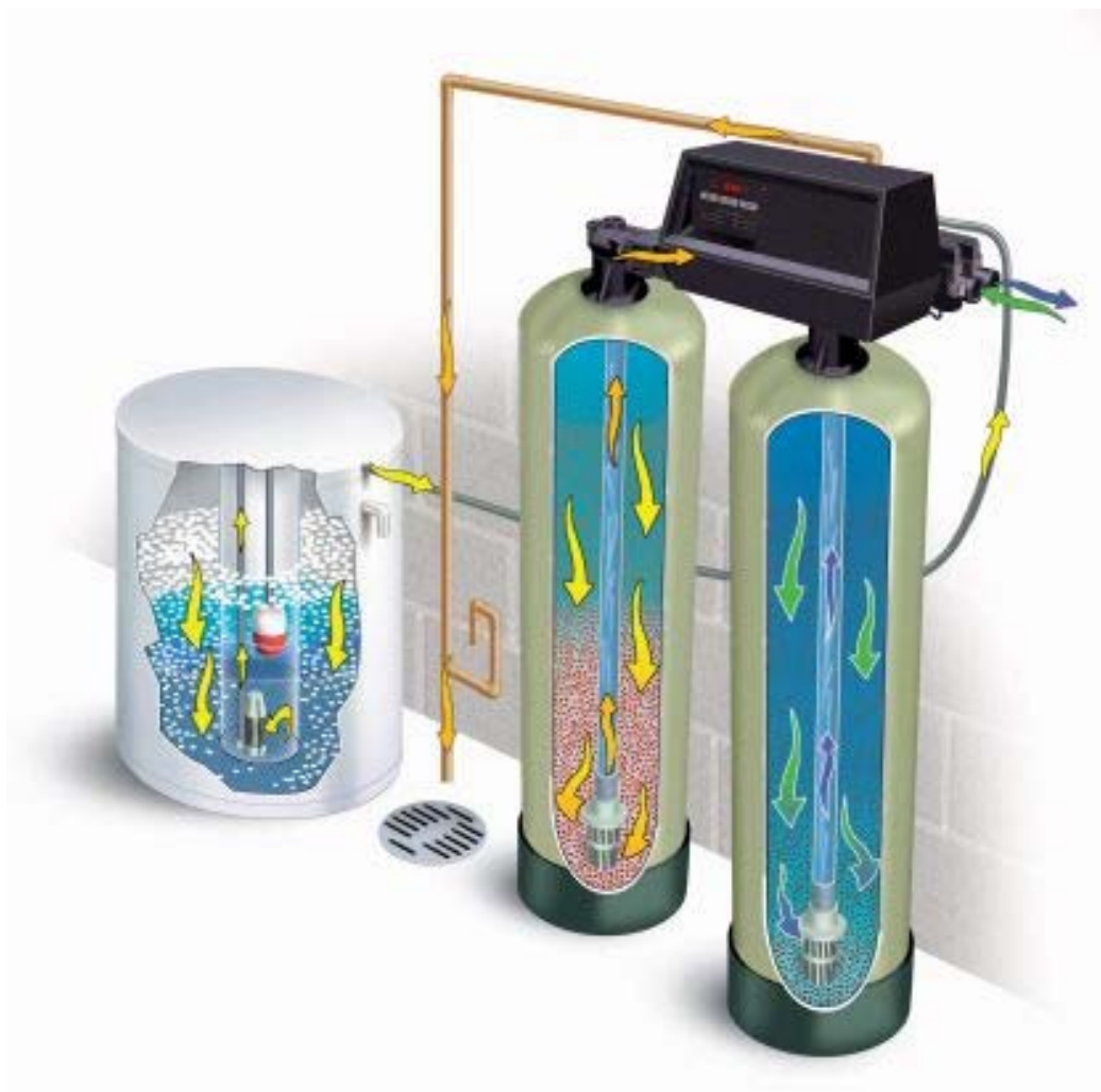
Рисунок 1.18 Установка умягчение воды
