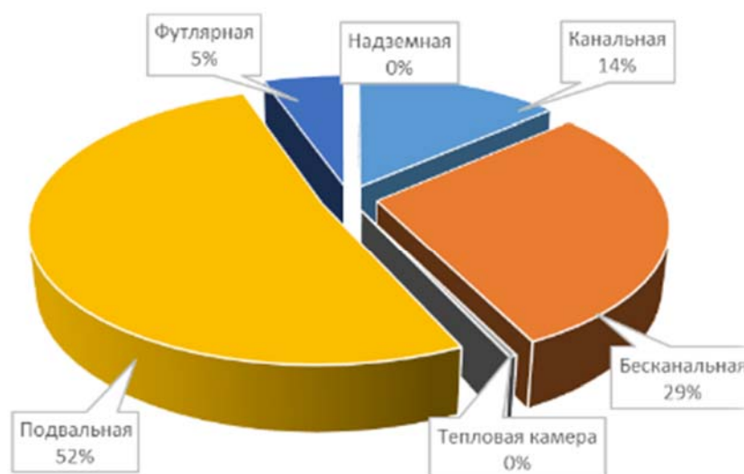
Рисунок 1.10 Распределение тепловых сетей котельной по типу прокладки
