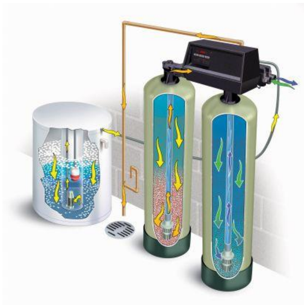
Рисунок 1.24 Установка умягчение воды
